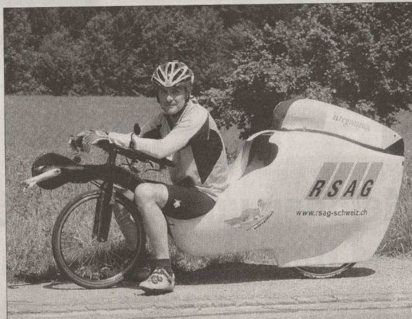
Im teilverkleideten, 12,5 Kilogramm schweren Liegerad ist der Luftwiderstand gering.
